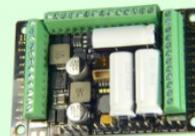
**MX699KV** (image), **MX699KS** Version avec borniers à vis (SOUND) successeur du MX695KV, MX695KS
